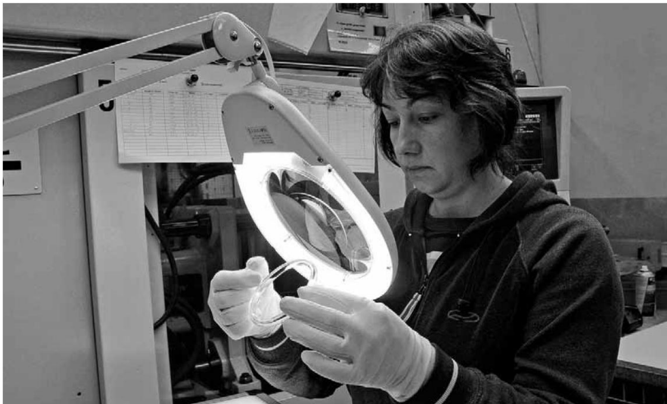
Jeder Kunststoffring wird unter der Lupe kontrolliert. Oksana Lukanowski überprüft die Ringe auf schadhafte Stellen.
